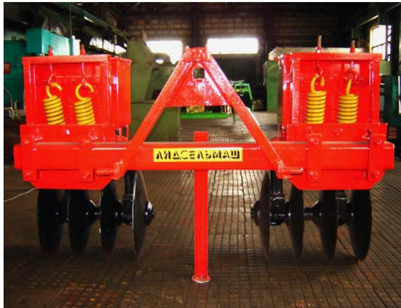
Предназначен для ухода за лесными культурами, посевными или посаженными по дну борозд, проложенных плугом ПКЛ-70Д, и на полосах, подготовленных лесной фрезой. Агрегатируется с тракторами МТЗ-52, МТЗ-80/82 тягового класса 1,4.
