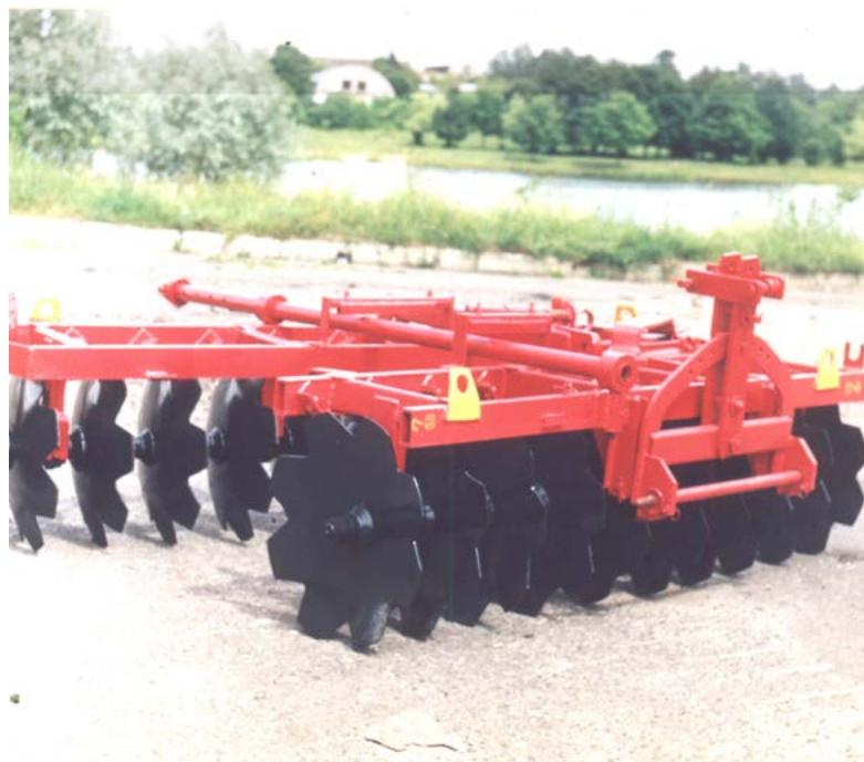
Предназначена для глубокого рыхления почвы и уничтожения сорняков в междуурядьях садов. В рабочем положении борона является прицепным орудием, а для дальнего транспортирования переналаживается и навешивается на трактор. Борона может использоваться для сплошной обработки полей. Борона не предназначена для работы на каменистых почвах.
