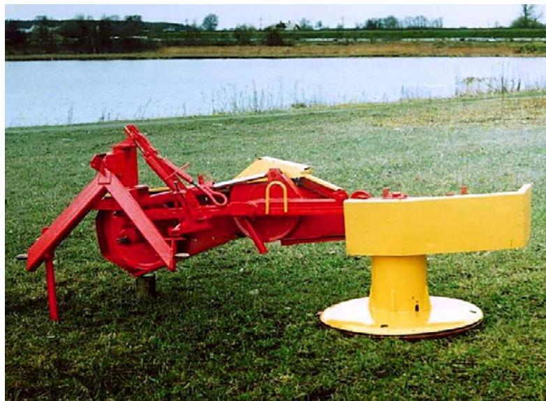
Предназначена для скашивания травы на полях и лугах, очищенных от камней и твердых предметов, и укладки ее в прокос. Агрегатируется с тракторами класса 1,4.
