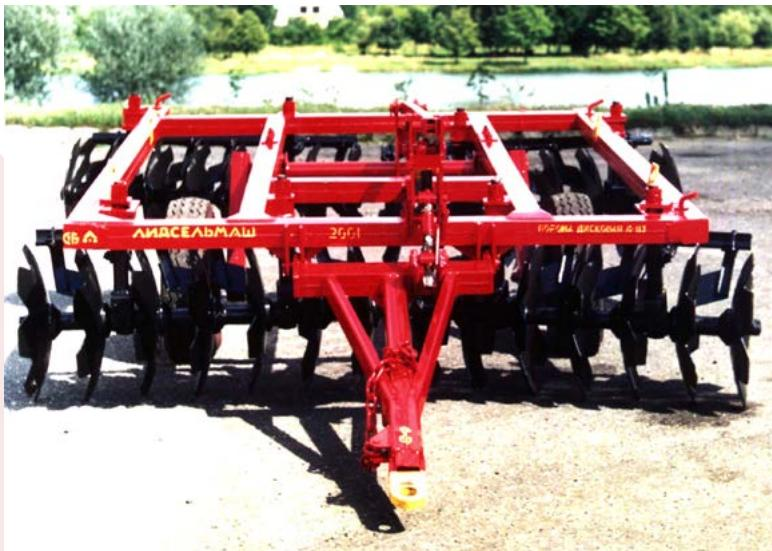
Предназначена для лущения стерни и предпосевной обработки почвы, разработки пластов первичной вспашки, поднятых кустарниково-болотными плугами, на минеральных и торфяных почвах, ухода за лугами и пастбищами, а также разделки глыб после вспашки.
