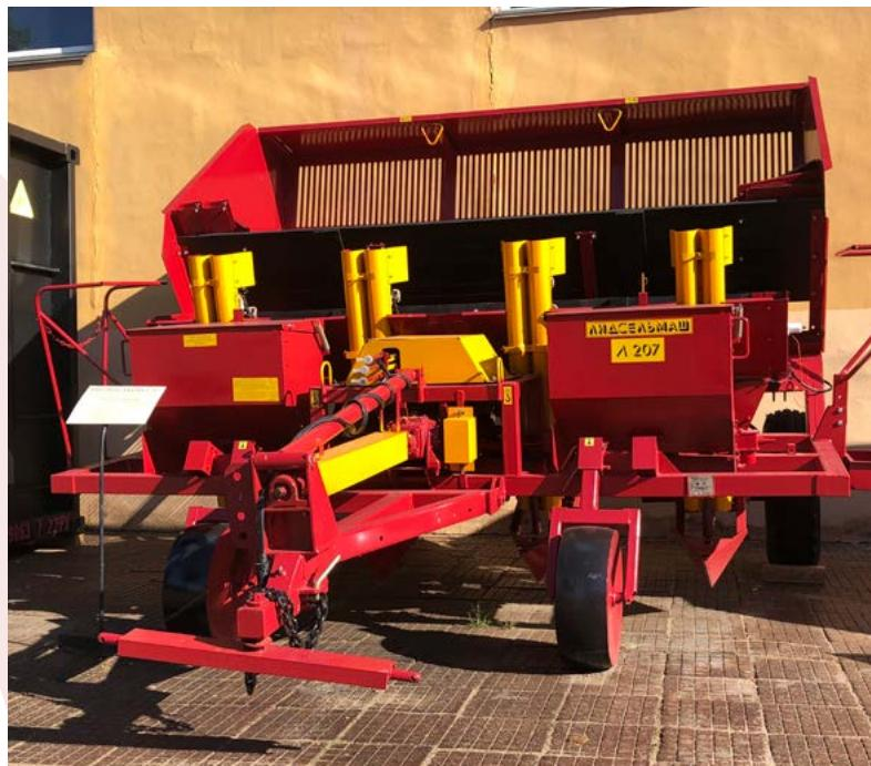
Картофелесажалка предназначена для рядковой посадки непророщенных клубней картофеля с междуурядьями 70, 75 или 90 см. Картофелесажалка агрегатируется с тракторами тягового класса 1,4. Загрузка картофелесажалки картофелем производится из любых самосвальных транспортных средств. Картофелесажалка оборудована туковысыевающими аппаратами.
