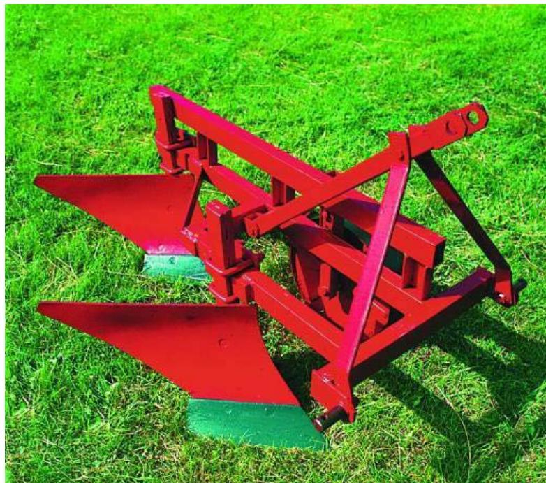
Предназначен для пахоты легких и средних по механическому составу старопахотных почв с удельным тяговым сопротивлением до 0,5 кг/см<sup>2</sup> на приусадебных участках и наделях. Используется во всех почвенно-климатических зонах. Агрегатируется с тракторами тягового класса 0,6.
