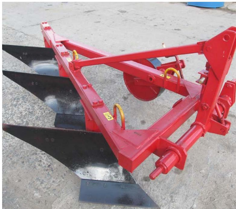
Предназначен для вспашки различных почв с удельным сопротивлением до 0,9 кг/см<sup>3</sup>, под зерновые и технические культуры во всех почвенно-климатических зонах. Агрегатируется с тракторами тягового класса 1,4.
