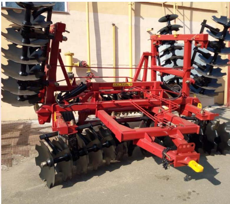
Предназначена для лущения стерни и предпосевной обработки почвы. Борона может использоваться в любых почвенно-климатических зонах.
