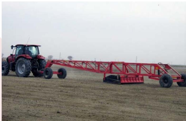
Планировщик полей предназначен для предпосевной и текущей планировки земель, предварительно очищенных от каменистых включений и древесных остатков.
