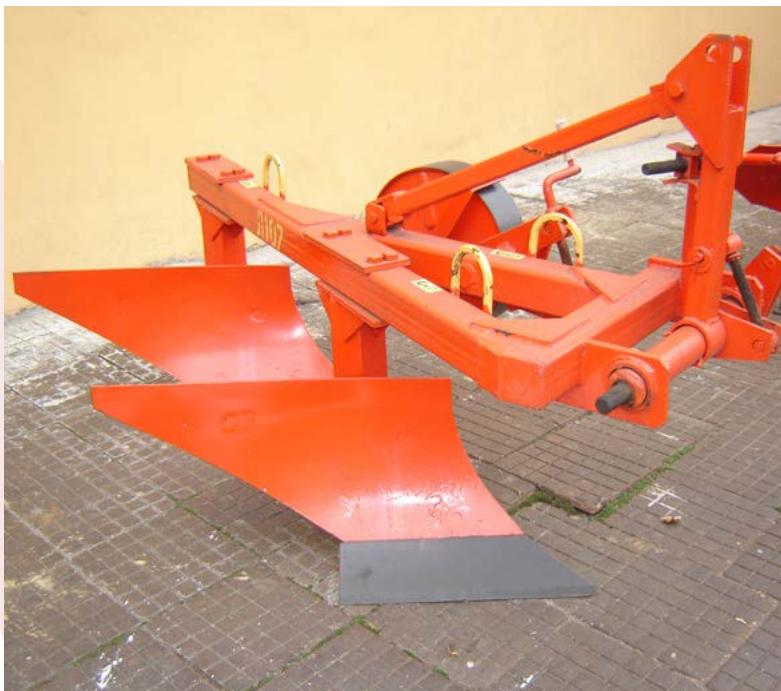
Предназначен для вспашки различных почв с удельным сопротивлением до 0.9 кг/см<sup>2</sup>, не засоренными камнями во всех климатических зонах. Агрегатируется с тракторами тягового класса 0.6; 0.9.
