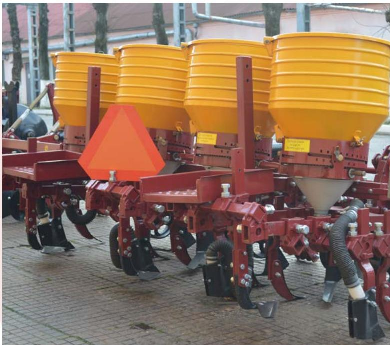
Предназначен для междурядной обработки хлопчатника и других высокостебельных культур в период вегетации, посеванных 4-рядными сеялками.
