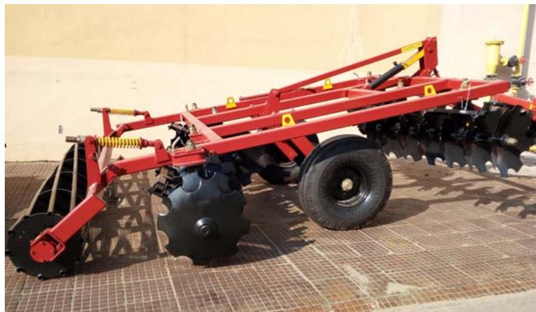
Предназначена для лущения стерни и предпосевной обработки почвы, разработки пластов первичной вспашки, поднятых кустарниково-болотными плугами, на минеральных и торфяных почвах, ухода за лугами и пастбищами, а также разделки глыб после вспашки.
