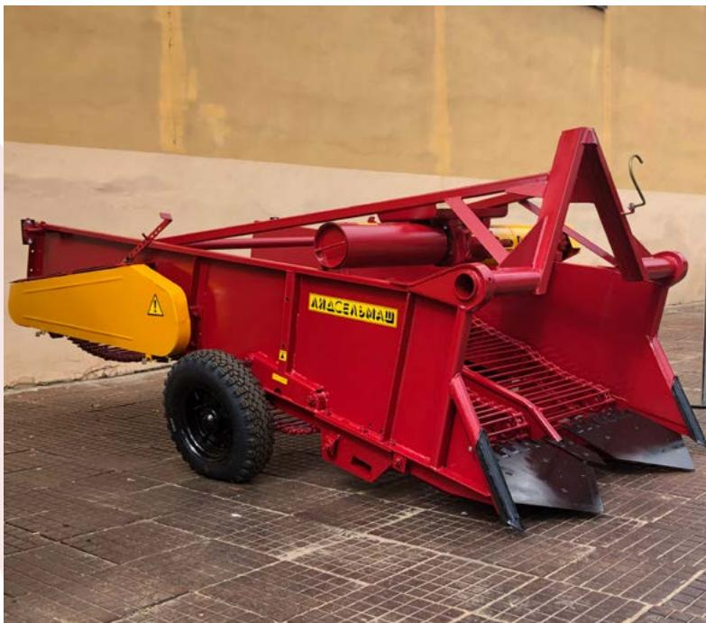
Картофелекопатель с элеваторами на прорезиненных ремнях предназначен для выкапывания картофеля, частичного отделения клубней от почвы и укладывания их на поверхность поля для дальнейшей подборки.
