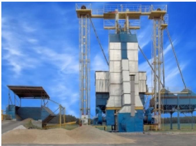
ОАО «Брестсельмаш» производит сушилки зерновые шахтные стационарного типа производительностью 20 и 30 плановых тон в час. Они предназначены для сушки всех видов зернобобовых, зерновых и масличных культур. По своей конструкции они оптимально подходят для сушки семенного зерна, рапса, риса, подсолнечника, сырой кукурузы (влажностью более 30%).
