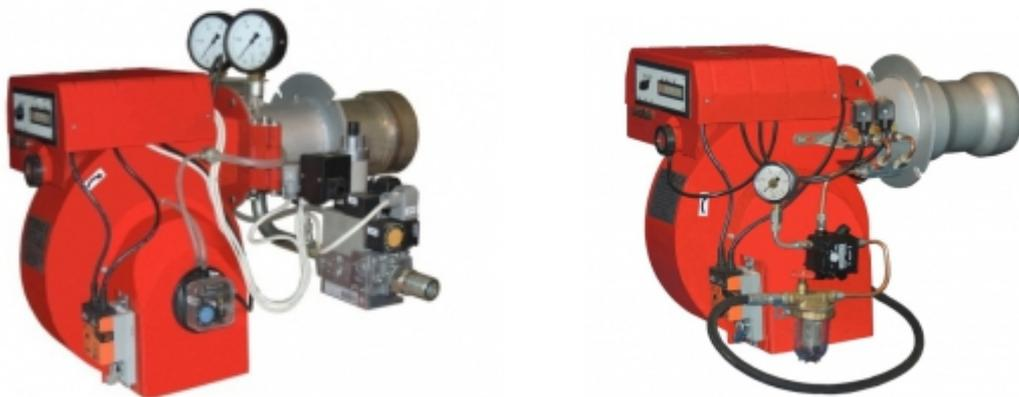
Горелки блочные марки ГБГ производятся тепловой мощностью от 0,2 до 3,5 МВт с двухступенчатым, плавным, модулируемым регулированием тепловой мощности. Комплекуются газовыми мультиблоками, приборами контроля герметичности, реле давления и сервомоторами немецких и швейцарских производителей.
